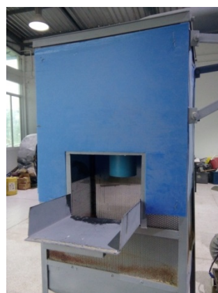
Figure 1 เครื่องอบแห้งแบบพาหะลมที่พัฒนาขึ้น
