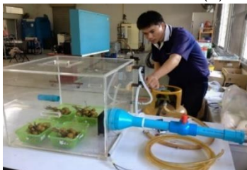
Figure 1 การเตรียมข้อมผลลำไยสด (ก) และการฉีดพ่นน้ำเพื่อเพิ่มความเป็ยกขึ้นบนผลลำไยสด (ข)
