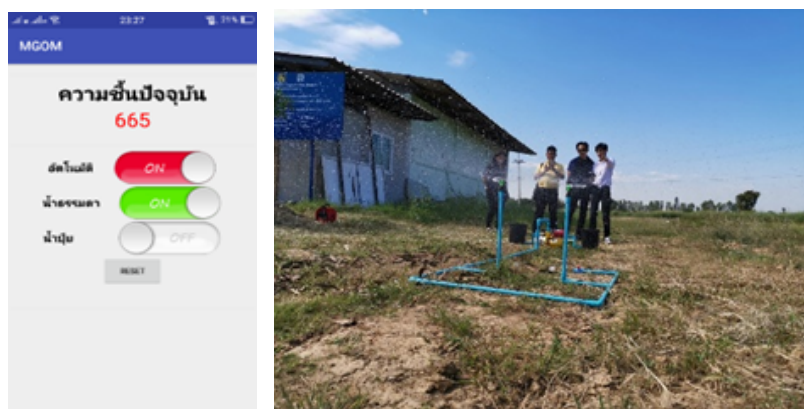
Figure 7 การเลือกรดน้ำอัตโนมัติเมื่อความชื้นสูงกว่าเกณฑ์ที่กำหนด
