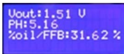
รูปที่ 2 ตัวอย่างของค่า Vout, ค่า pH และค่า %oil/FFB บนตัวเครื่อง
